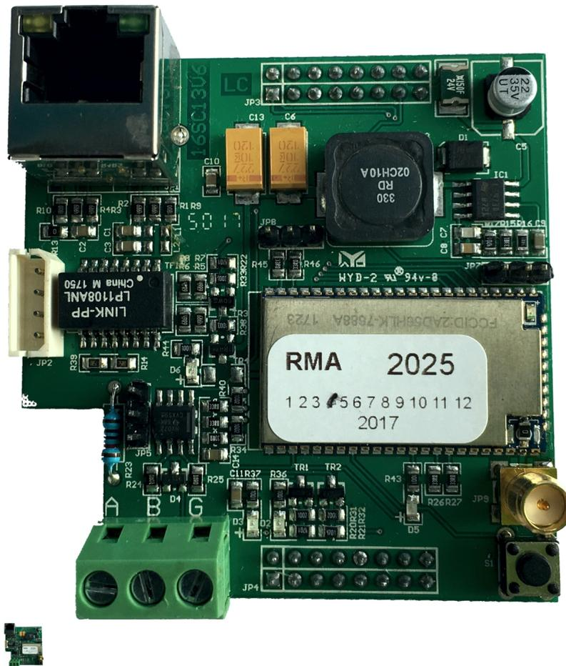
Scheda plugin wifi (access point, connessione sistema domotico, gestione videoverifica)
